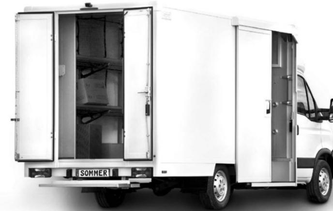
Der für den Kurier- Express- und Paketdienst optimierte Integralkoffer **SOMMER TIL** bietet Ihnen alles, was Sie für die effiziente Auslieferung benötigen: Einen großen Laderaum, rutschsichere Staumöglichkeiten dank Regalen mit Sicherheitskante, breite Durchgänge und verriegelbare Türen.
