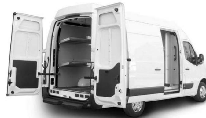
Der Kastenwagen-Regalausbau SOMMER TA bietet dank optimaler Raumausnutzung großzügige Staumöglichkeiten sowohl in den Regalböden als auch für sperrige Güter. Eine robuste Bauweise mit 200 kg Traglast pro Regalboden und eine stabile Trennwand mit verriegelbarer Schiebetür sind bei SOMMER selbstverständlich.
