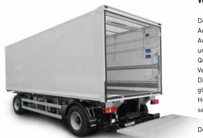
Der SOMMER AG lässt sich auf Wunsch mit Rolltor oder mit Ladebordwand ausstatten.
