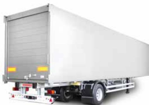
Statt mit den serienmäßigen Portaltüren lässt sich der SG auch mit Rolltor oder Ladebordwand ausstatten.
