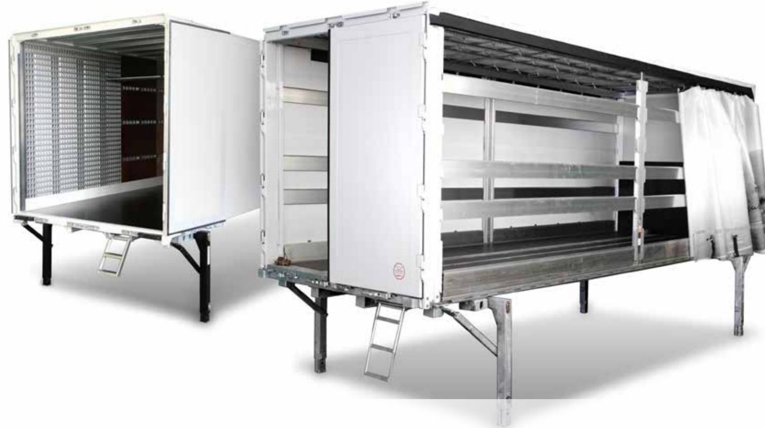
Die Wechselbehälter SOMMER WG und SOMMER WP sind in unterschiedlichen Bauhöhen und Längen verfügbar.
