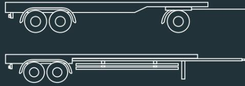
DER PASSENDE ANHÄNGER FÜR ALLE WECHSELBEHÄLTER: DER DREHSCHEMEL-WECHSELANHÄNGER SOMMER AW EBENSO WIE DER ZENTRALACHS-WECHSELANHÄNGER SOMMER ZW SIND MIT UNTERSCHIEDLICHEN FAHR- UND ABSTELLHÖHEN VERFÜGBAR.
