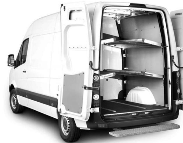
Der Kastenwagen-Regalausbau SOMMER TA bietet dank optimaler Raumausnutzung großzügige Staumöglichkeiten sowohl in den Regalböden als auch für sperrige Güter. Eine robuste Bauweise mit 200 kg Traglast pro Regalboden und eine stabile Trennwand mit verriegelbarer Schiebetür sind bei SOMMER selbstverständlich.
